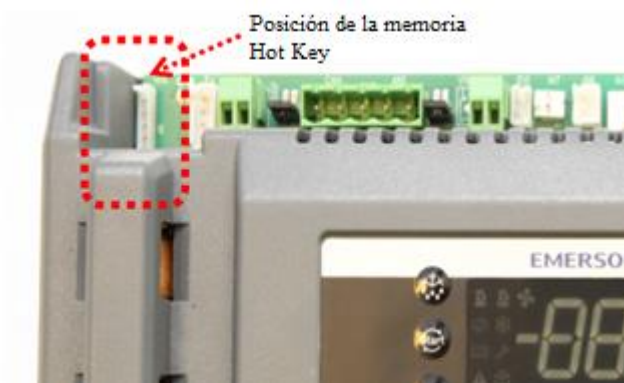
Figura 19: Localización de la conexión de la memoria "Hot Key"
